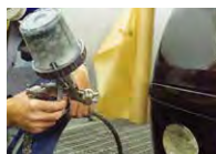
Atelier de carrosserie Application de peinture nécessitant une grande qualité d'air (propre et sec)
