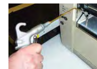
Atelier d'usinage Utilisation de soufflettes pour le nettoyage des pièces
