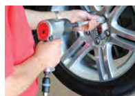
Garage Utilisation d'outils nécessitant un grand volume d'air (outils à impact)
